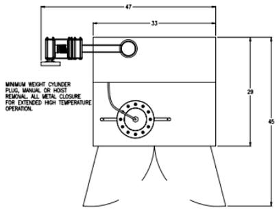
MINIMUM HEIGHT CYLINDER PLUG, MANUAL OR HOIST REMOVAL, ALL METAL CLOSURE FOR EXTENDED HIGH TEMPERATURE OPERATION.
